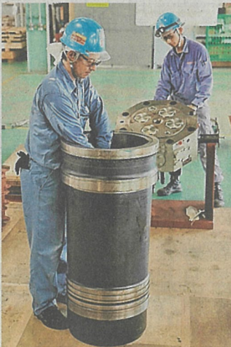
船舶に搭載するエンジンのシンターを点検、計測する従業員
